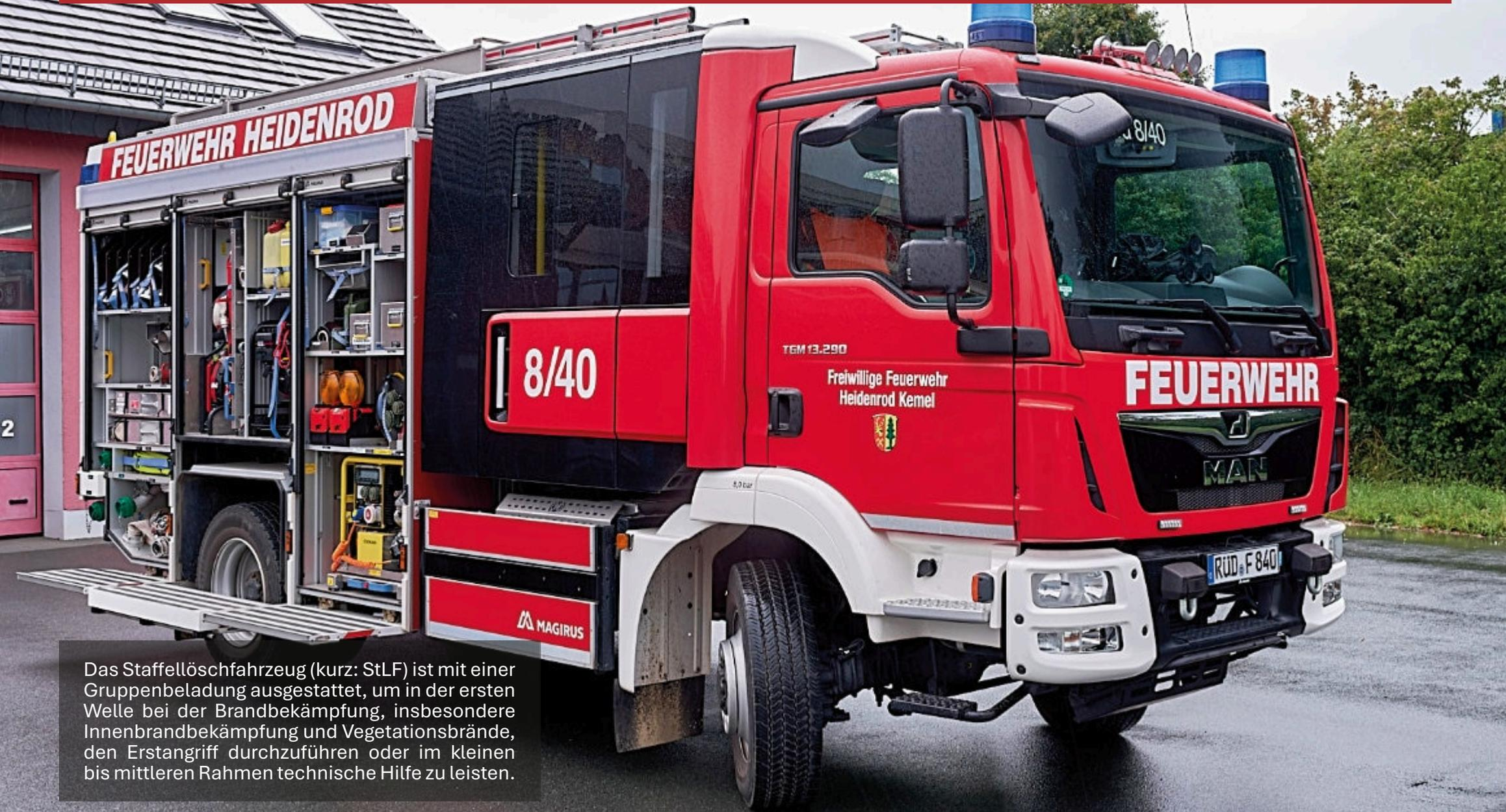
Das Staffellöschfahrzeug (kurz: StLF) ist mit einer Gruppenbeladung ausgestattet, um in der ersten Welle bei der Brandbekämpfung, insbesondere Innenbrandbekämpfung und Vegetationsbrände, den Erstangriff durchzuführen oder im kleinen bis mittleren Rahmen technische Hilfe zu leisten.
