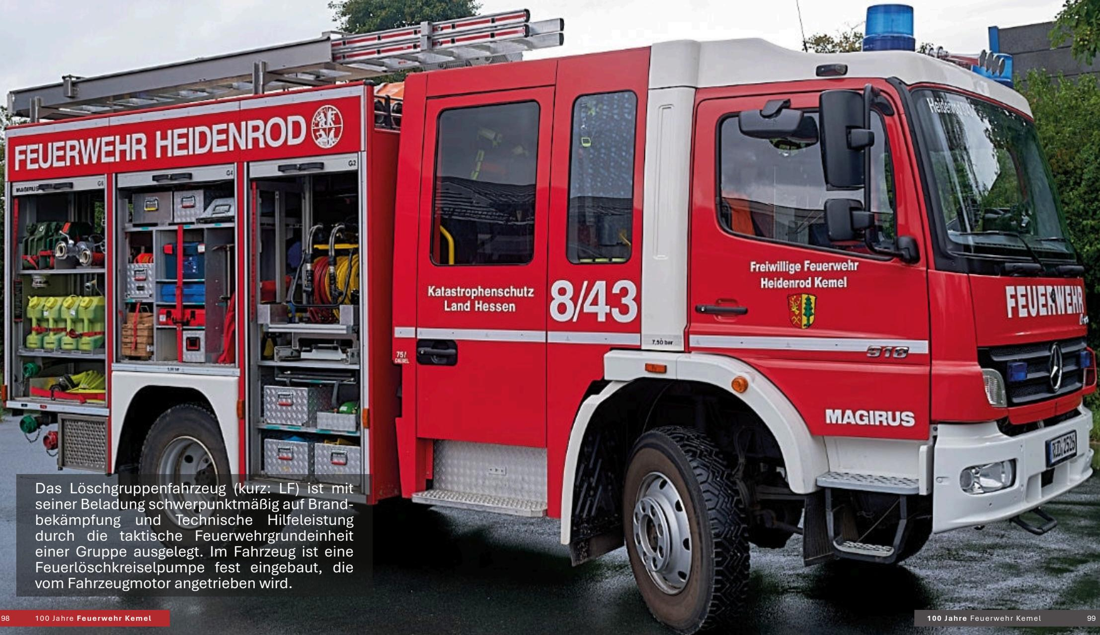
Das Löschgruppenfahrzeug (kurz: LF) ist mit seiner Beladung schwerpunktmäßig auf Brandbekämpfung und Technische Hilfeleistung durch die taktische Feuerwehrgrundeinheit einer Gruppe ausgelegt. Im Fahrzeug ist eine Feuerlöschkreiselpumpe fest eingebaut, die vom Fahrzeugmotor angetrieben wird.
